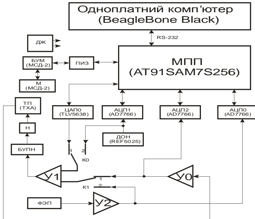
Рис. 1. Блок-схема універсальної установки для вимірювання термостимульованої люмінесценції
