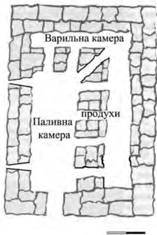
Рис. 2. Реконструкція плану склоробної печі за С. Мартинюком
