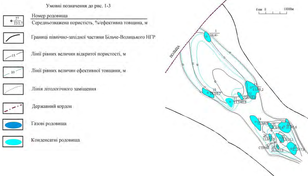
Рис. 2. Схематична карта усереднених значень пористості порід-колекторів та ефективних товщин горизонту НД-9 сарматських відкладів.
