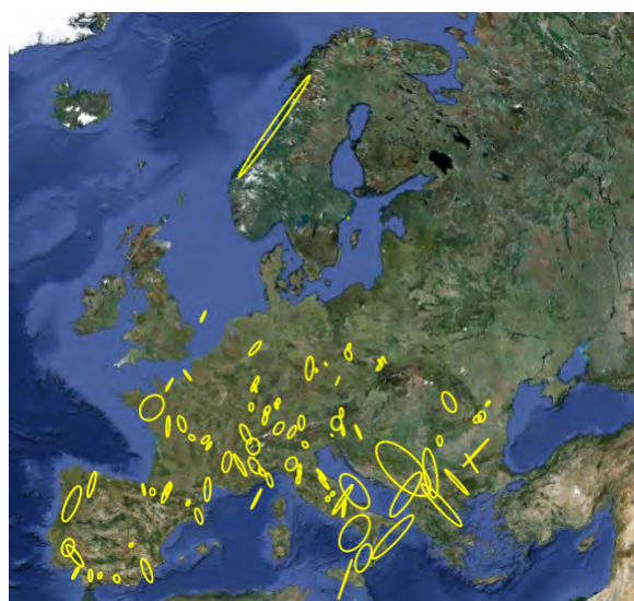
Рис. 11. Картосхема з еліпсами розсіювання епіцентрів землетрусів на території Європи за даними сейсмічних станцій для 2007 р.
