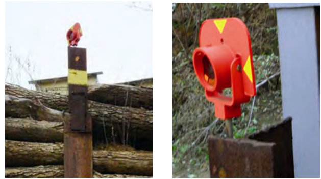
Рис. 8. Вид закрепленных призмных отражателей
