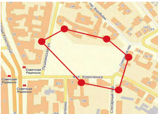
Рис. 6. Схема внешней опорной сети
