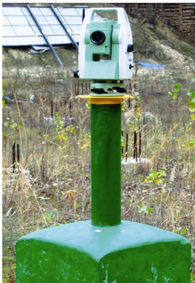
Рис. 3. Пилон с установленным прибором
