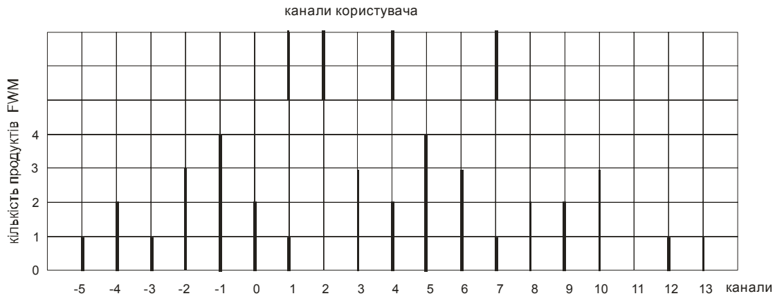
Рис. 4. Розподіл продуктів FWM для чотирьох, нерівномірно розміщених вхідних сигналів
