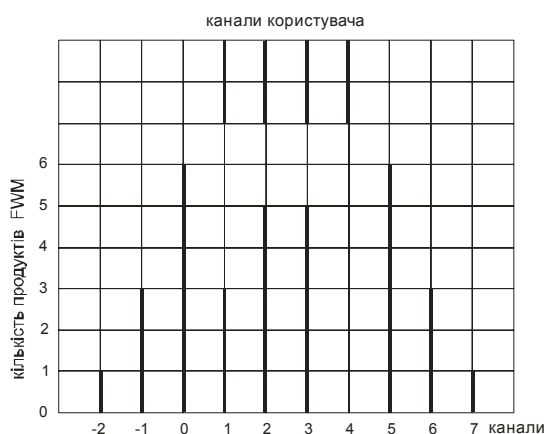
Рис. 2. Розподіл продуктів FWM для трьох, рівномірно розміщених вхідних сигналів
