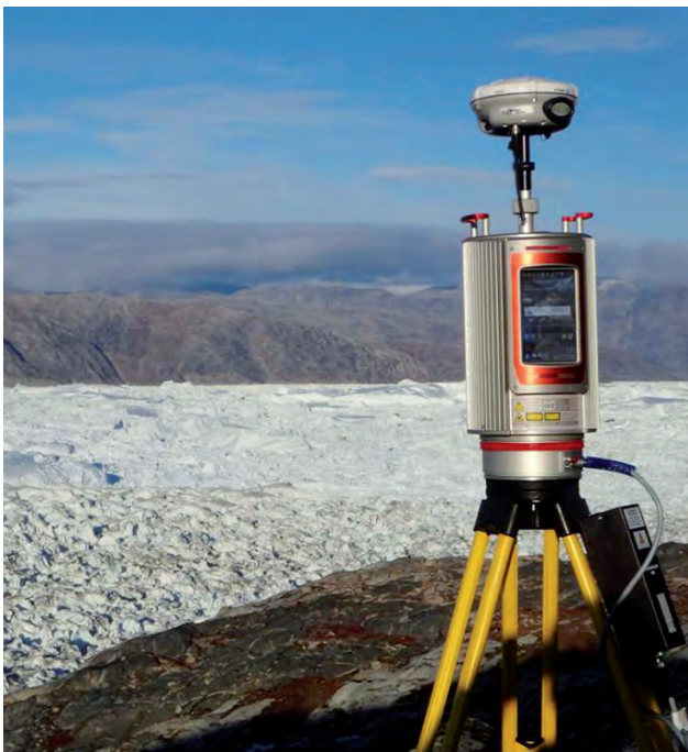
Рис. 8. Сканування просторів Гренландії за допомогою наземного лазерного сканера Riegl VZ-6000
