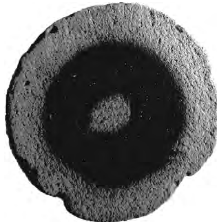
Рис. 7. Структура випаленого взірця, сформованого з відходів збагачення вугілля з добавкою крейди та манганового концентрату
