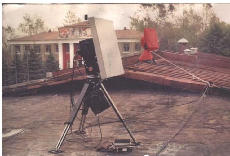
Рис. 4. Приймально-передавальна станція комплексу «Епіграма»
