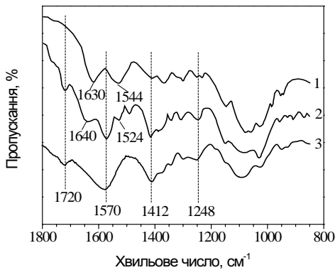
Рис. 15. ІЧ-спектри з перетворенням Фур'є хітозану (1) і частинок Хіт-ОП, одержаних при рН 4,3 і співвідношеннях \text{COOH}:\text{NH}_2 0,4 (2) або 0,9 (3).
