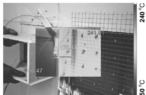
Рис. 5. Вигляд матриці із чутливими маркерами температури
