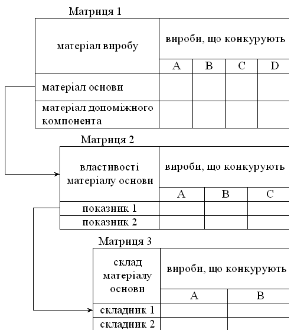
Рис. 3. Типові матриці для реалізації зворотного інженерного аналізу
