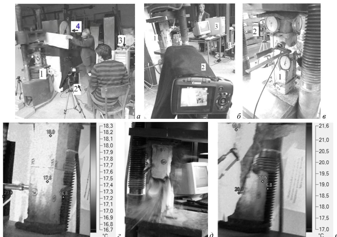
Рис. 4. Випробування призми П-2: а – загальний вигляд випробування (1 – прес з призмою, 2 – тепловізор з реєстратором відео, 3 – ПК «АКЕМ», 4 – шкала преса), б – відеозапис тепловізора, в – вигляд призми з мікроіндикаторами (5) та датчиком АЕ (6), г – вигляд розподілу температурного поля в момент перед руйнуванням, д – момент руйнування призми
