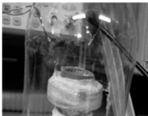
Рис. 4. Устава з LC-схемою для нагрівання МНЧ. Складається з генератора функцій, височастотного підсилювача та котушки
