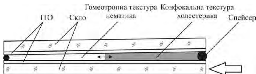
Рис. 2. Схематичне зображення аналогового сенсора напруги на основі ефекту ХНП
