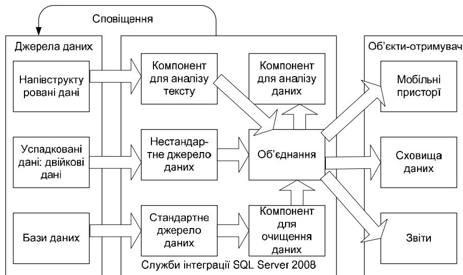
Рис. 3. Схема інтеграції SSIS
