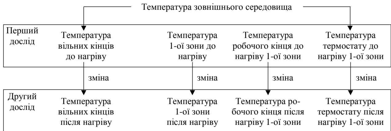
Рис. 2. Схема експериментального дослідження методичної похибки ТЕП з КПТП
