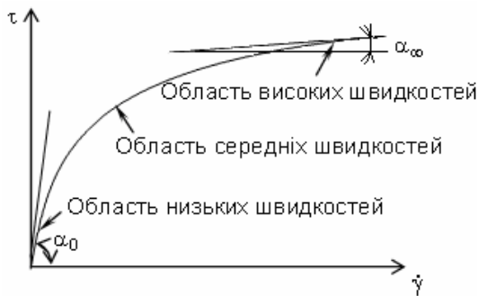
Рис. 3. Реологічна крива псевдопластичної течії
