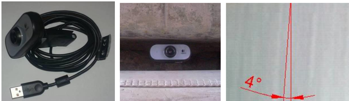
Рисунок 3 – Комплект з відеокамерою і розміщення її на автомобілі та фрагмент запису кута відведення його задньої осі
