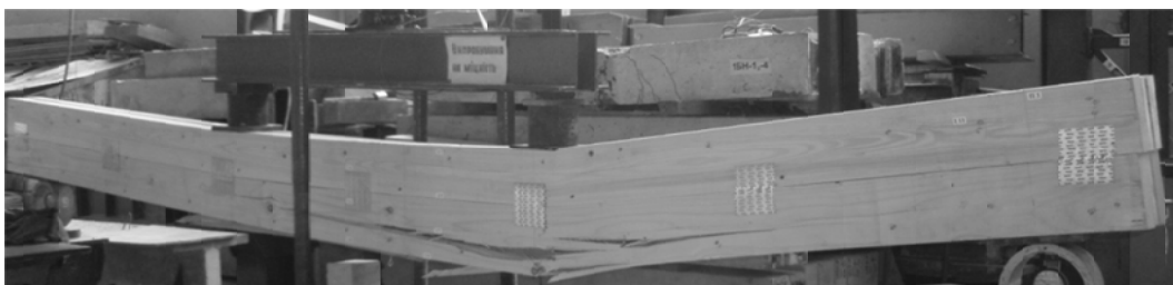
Рис. 7. Руйнування балки Б-2 за I групою граничних станів
