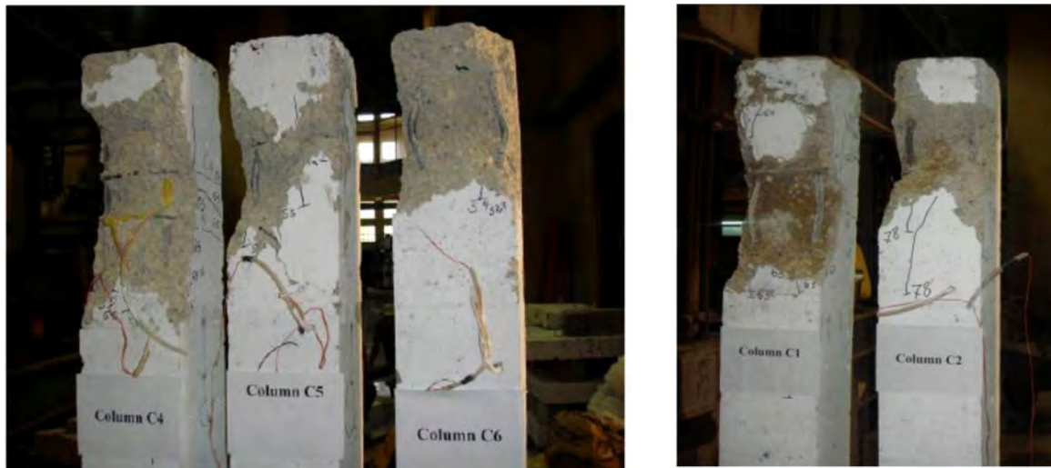
Рис. 4. Характерні пошкодження колон, навантажених осьюовою силою (Rabi M.)
