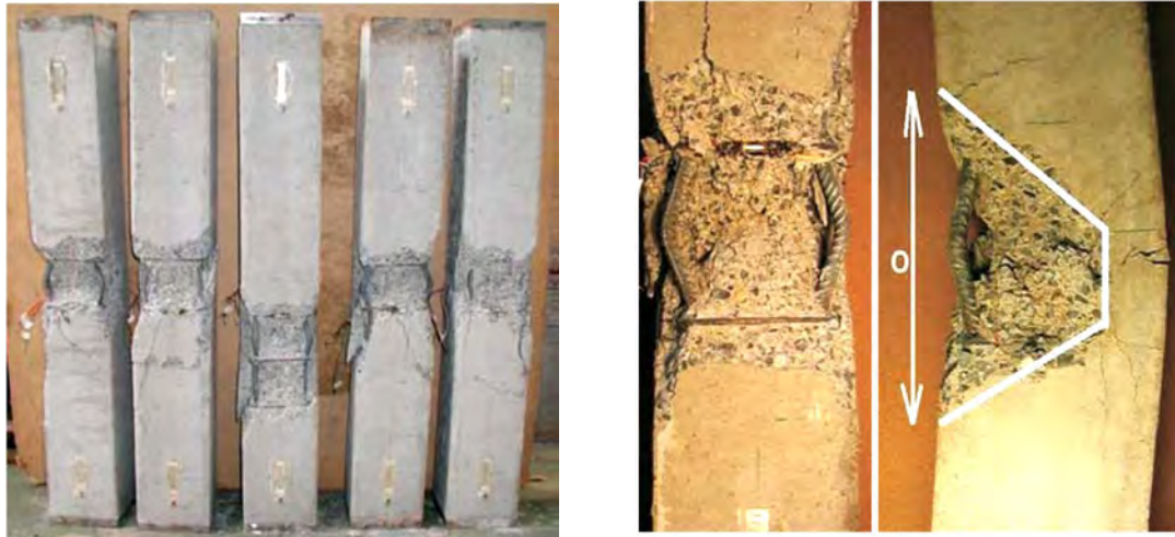
Рис. 3. Характерні пошкодження колон, навантажених осьюовою силою (J. Němeček)
