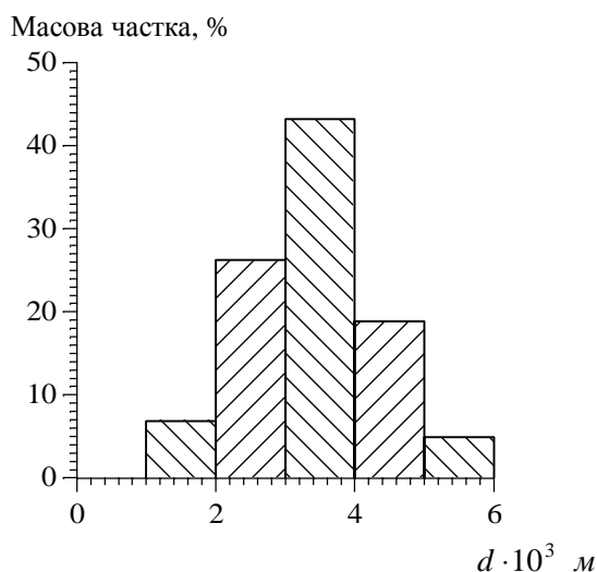
Рис. 1. Гранулометричний склад амофосу
