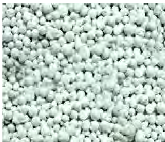
Рис. 2. Гранульований амофос з діаметром частинок 1–5 мм
