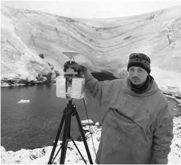
Рис. 4. Визначення координат марки та сканера методом ГНСС
