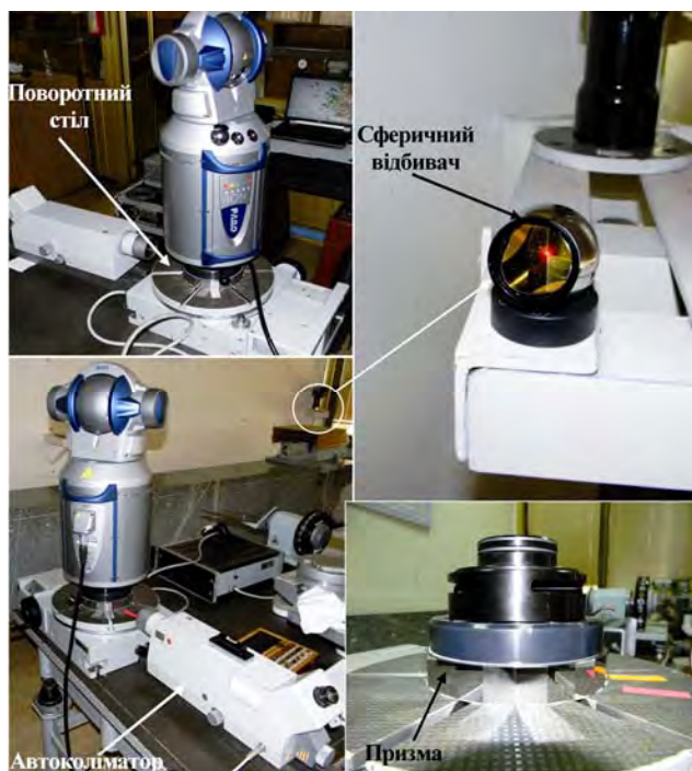
Рис. 1. Дослідження лазерного трекара на поворотному столі
