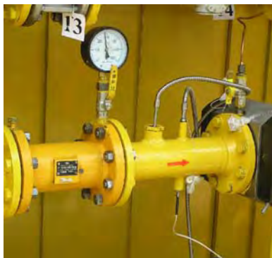
Рис. 1. Вузол обліку природного газу із встановленими термоперетворювачами для дослідження похибки \Delta T_T
