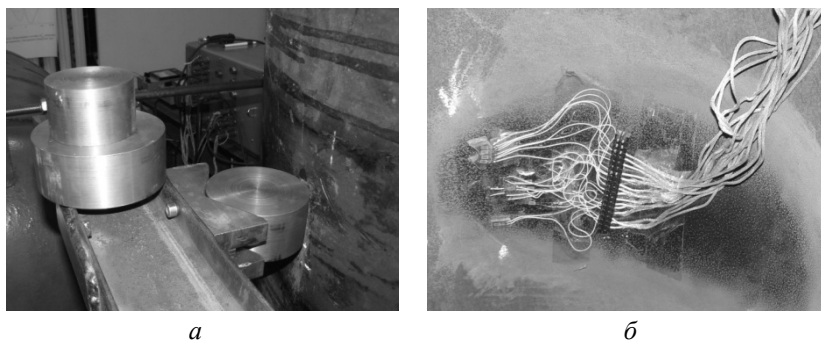
Рис. 5. Експериментальна установка: а – задня траверса; б – тензорезистори
