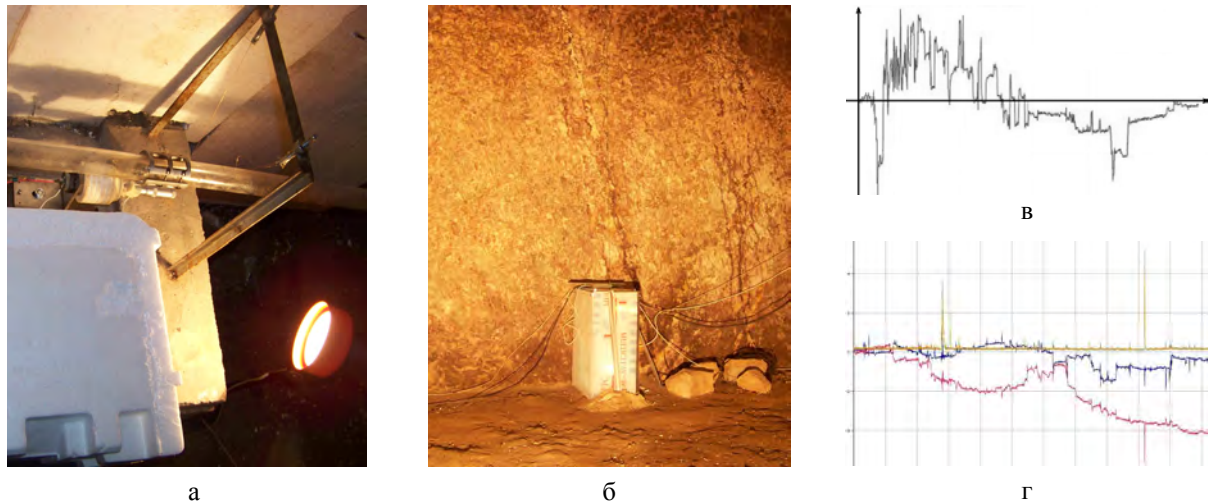
Рис. 12. Кварцовий деформограф (а), нахиломір (статичний маятник) та контрольована зсувна зона (б) у тілі масиву гірських порід (андезитів) штольні РГС “Берегове” і зміщення бортів цієї зони за даними деформографа (в) та нахиломіра (г) під час сейсмічних подій
