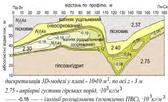
Рис. 6. Шаварівська дільниця Немирівського родовища сірки. Розріз тривимірної моделі зон розуцільнення у межах контурів продуктивного пласта після виплавки сірки
