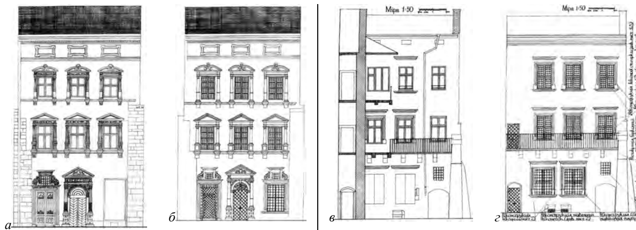
Рис. 2. Столярка головного та тильного фасадів будинку на пл. Ринок, 28: а, в – існуючий стан (XIX–XX ст.); б, г – теоретична реконструкція (кін. XVI – поч. XVII ст.) (креслення Т. Казанцевої)
