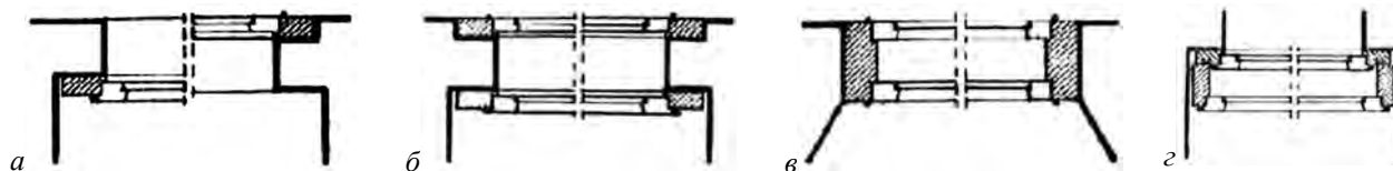
Рис. 1. Схеми конструктивного вирішення вікон: а – одинарне “кроснове” вікно; б – подвійне “кроснове” вікно; в – подвійне “навстіжне” вікно; г – “скринькове” вікно (за Я. Тайхманом)
