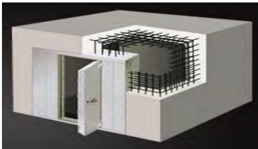
Рис. 1. Екрановане серверне приміщення
