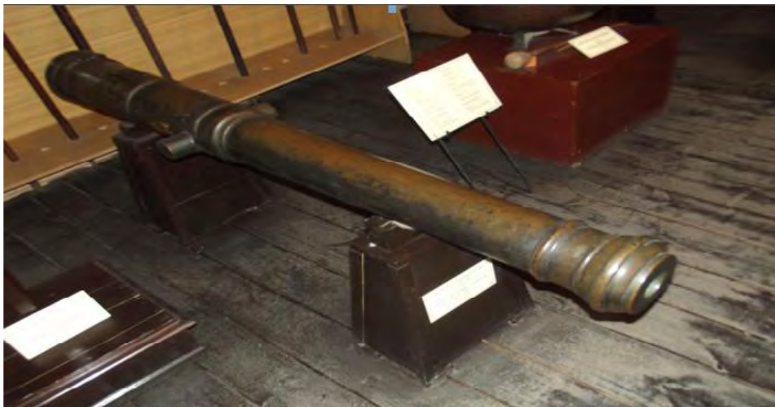
Рис. 4. Гармата однофунтова (фалькон). Львів. Сер. XVI ст. Майстер Леонард Герле. Бронза. Калібр 53,3 мм
