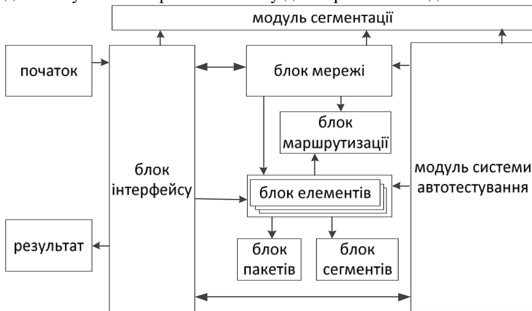
Рисунок 17. Структурна схема симулятора мережі на кристалі MDTNoC
