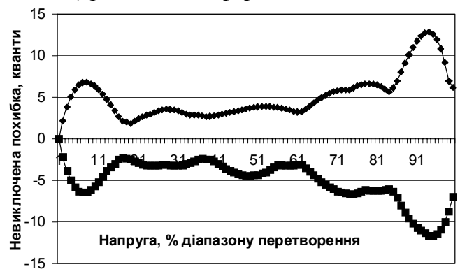
Рис. 11. Метод 3 формування точок визначення нелінійної складової похибки АЦП
