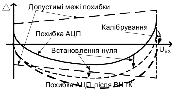
Рис. 1. Зміни похибки ФП АЦП при ВНТК
