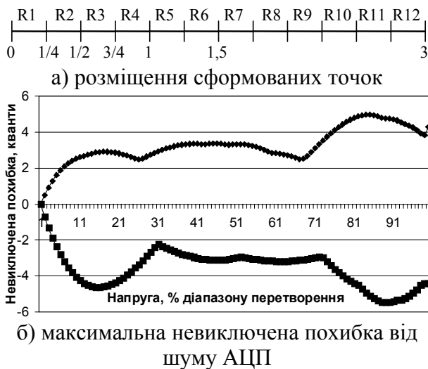
Рис. 12. Метод 4 формування точок визначення нелінійної складової похибки АЦП
