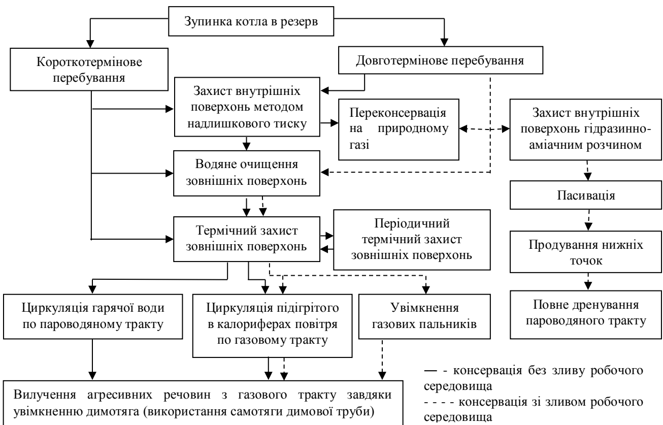
Рис.7. Алгоритм захисту котла під час простоювання.
