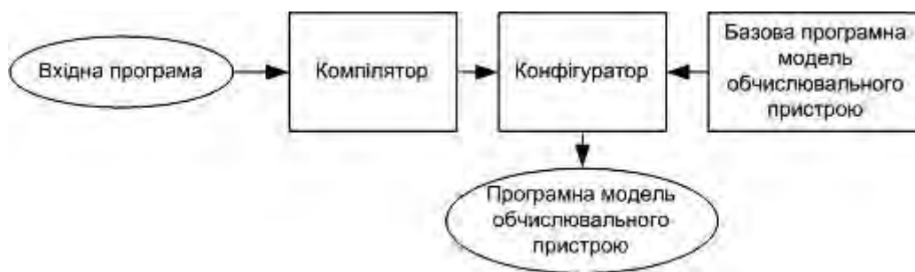
Рис. 2. Схема роботи засобів проектування на системному рівні, які використовують підхід конфігурування базової програмної моделі обчислювального пристрою
