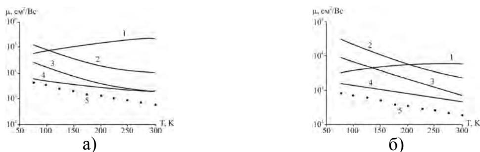
Рисунок Температурна залежність рухливості носіїв заряду для PbTe:Bi із врахуванням розсіювання носіїв на: короткодіючому потенціалі вакансій (1), акустичних фонах (2), оптичних фонах (3), домішці (4); а) 0,25 ат. % Bi і б) 1 ат% Bi.
