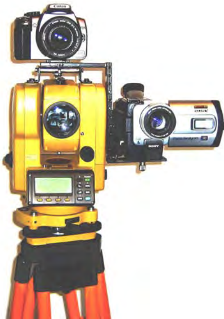
Рис. 3. Діючий макет фототеодоліта
