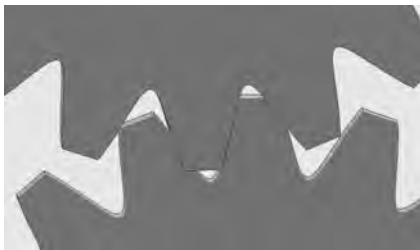
Рис. 4. Підбір параметрів синусоїдального профіля, еквівалентних евольвентному m=5, z=22, \alpha_o=20^\circ, \beta=0^\circ
