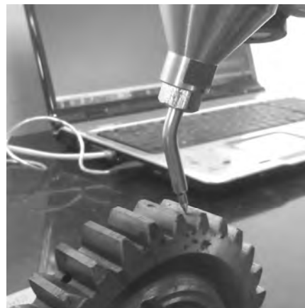
Рис. 1. Сканування зубчастого колеса за допомогою КВМ FARO Laser ScanArm
