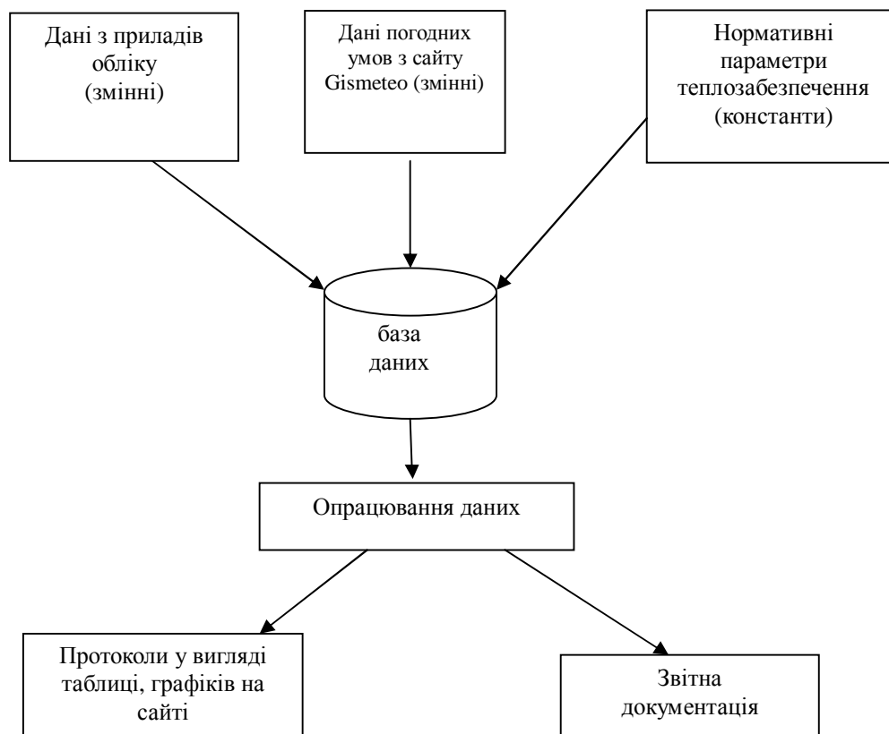
Рис .3. Схема функціонування системи моніторингу теплоспоживання будівлями СумДУ
