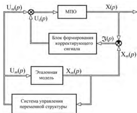
Рис. 1. Функциональная схема робастной системы управления Для приближенного уравнения вектора ошибок робастной системы стабилизации
