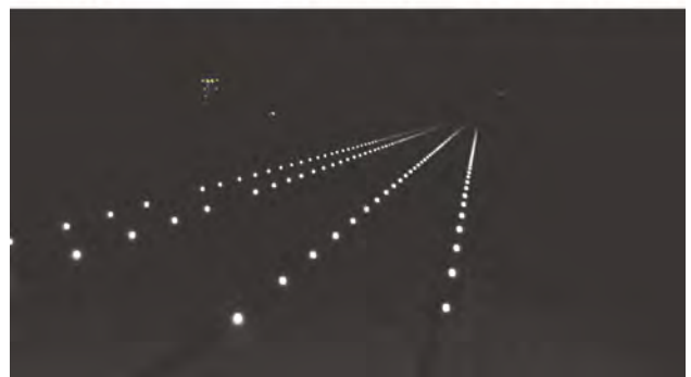
Рис. 6. Використання відбивних пластин для моніторингу залізничного полотна
