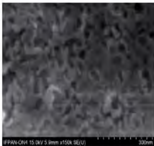
Рис. 2. Електронна мікрофотографія порошку алюмоітрієвого гранату
