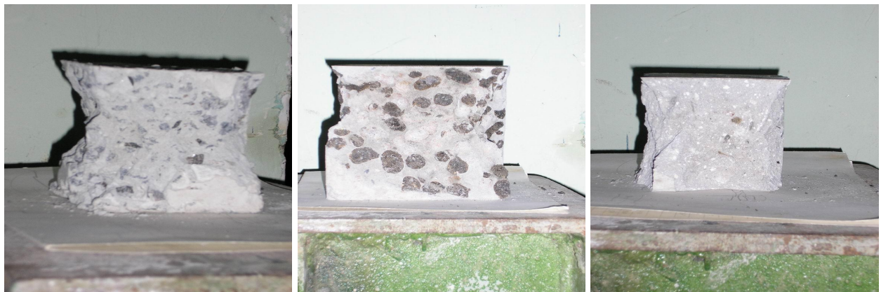
Рис. 1. Зразки кубів після випробування: а – важкий бетон; б – керамзитобетон; в – пінобетон
