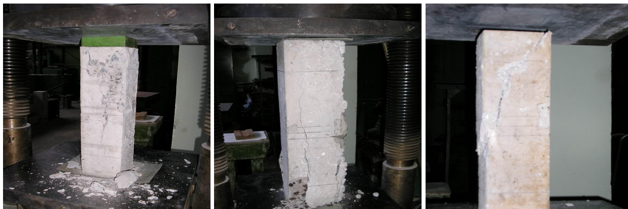
Рис. 2. Зразки призм після випробування: а – важкий бетон; б – пінобетон; в – керамзитобетон
