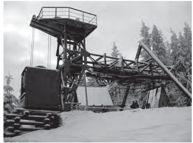
Рис. 5. Нижня станція канатно-бугельного підйомника у Тисовці, що в галицькій Бойківщині
