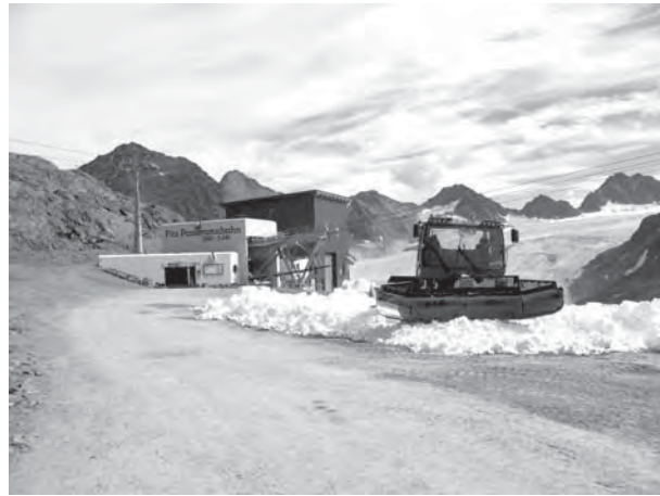
Рис. 2. Снігоробна машина („snow maker”) у вигляді великої кубічної споруди за нижньою станцією тондольної канатної дороги „Пітц-панорамабан” на льодовику Пітцталъ у Тіролі (Австрія). На передньому плані снігопрепарувальна машина, znana як „ратрак”
