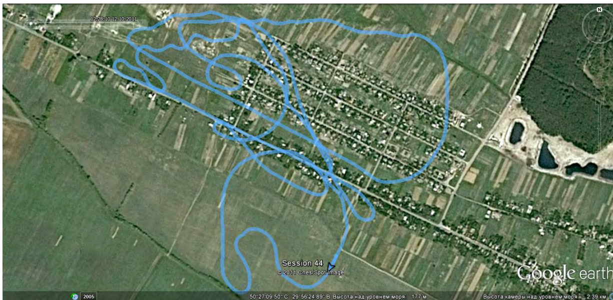
Рис. 4. Схема переміщення БПЛА під час кабрирування, заходження на маршрути, проходження маршрутів та глісади
