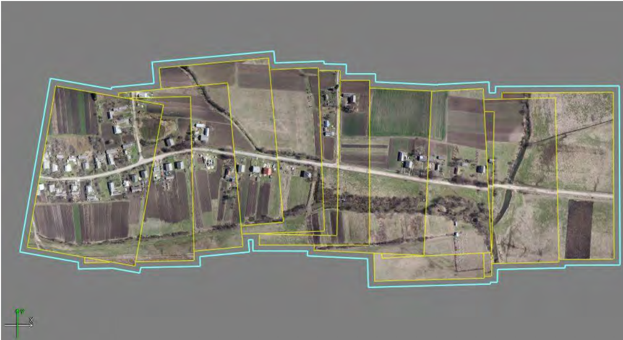
Рис. 8. Накидний монтаж маршруту (вісь маршруту – вулиця)
