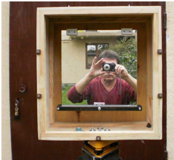
Рис. 3. Лабораторний взірець дзеркального відбивача з прямовисно встановленою відбиваючою поверхнею
