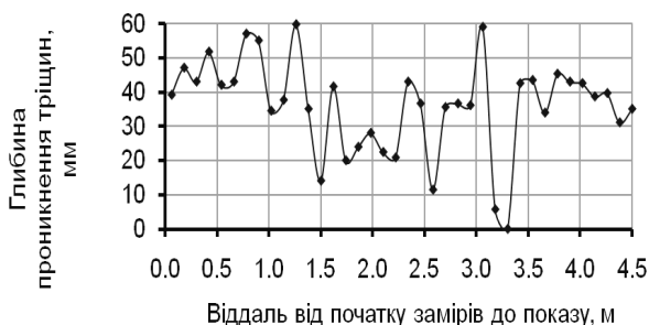
Рис. 6. Глибина тріщин та дефектів у бетоні фундаменту за гранню 1
