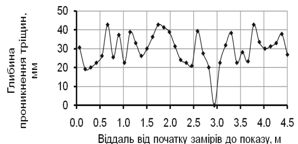
Рис. 7. Глибина тріщин та дефектів у бетоні фундаменту за гранню 3
