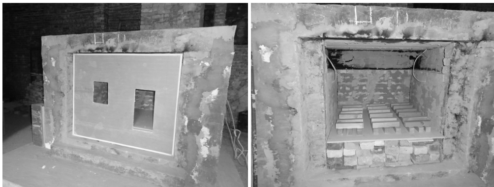
Рис. 1. Вигляд дослідної печі: а – розташування пожежного навантаження; б – гіпсокартонна стінка з модельними отворами
