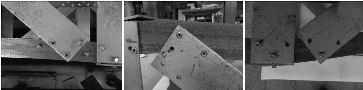
Рис. 6. Руйнування кріплення планок та розкосів колон марки К-2, К-3, К-4 відповідно
