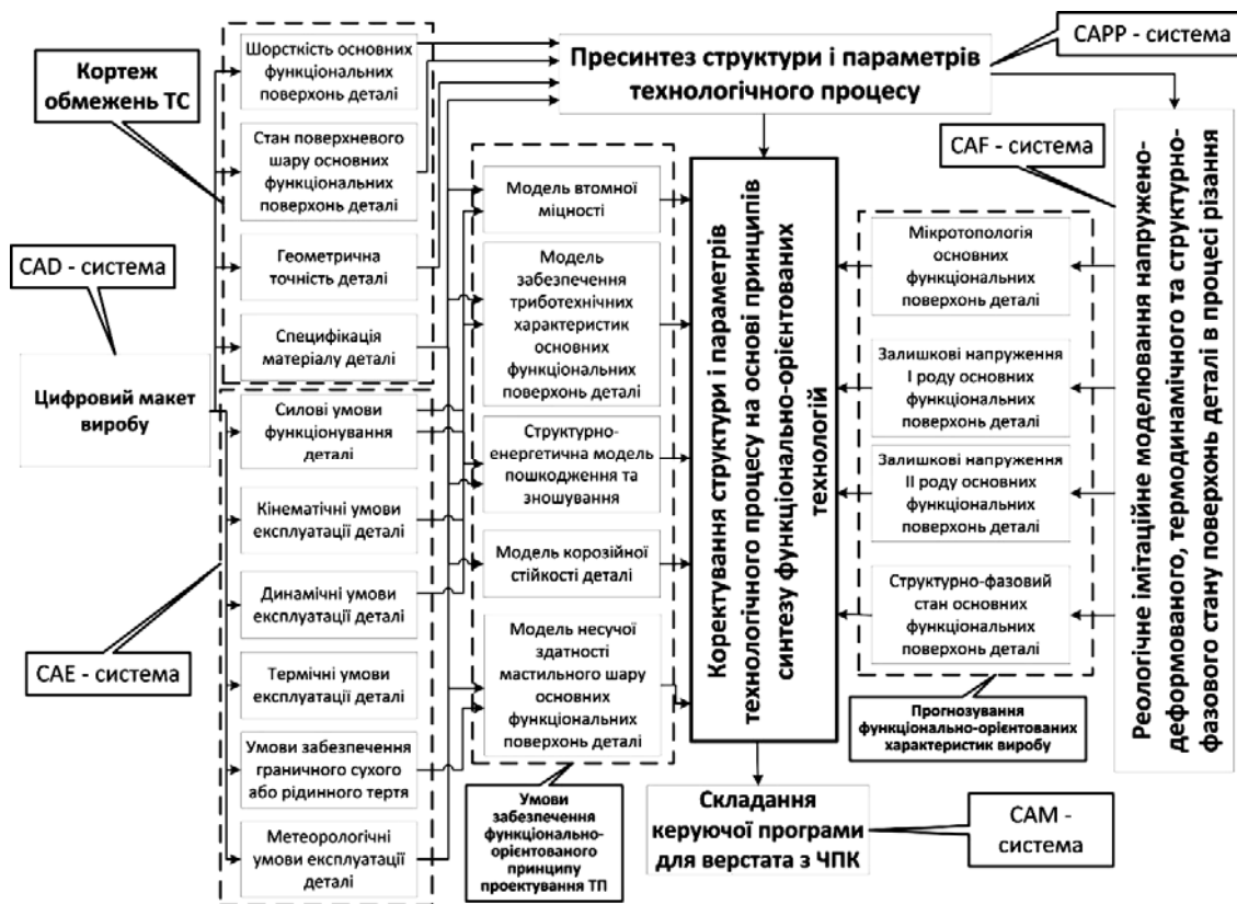
Рис. 3. Структурно-логічна схема технологічної підготовки виробництва за функціонально-орієнтованим принципом
